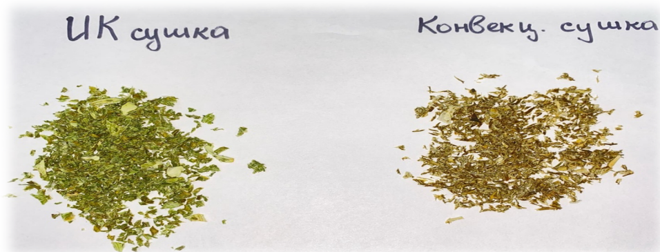
Рисунок 1 – Высушенная твердая фракция алоэ: сравнение внешнего вида после ИК и конвекционной сушек
